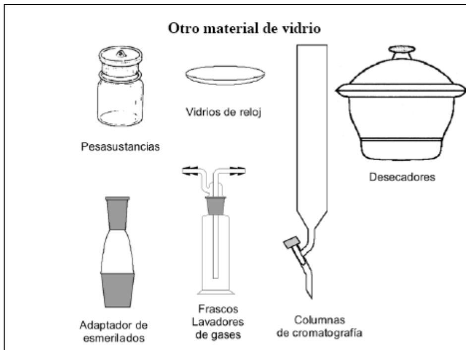
Imagen 7. Material de laboratorio: otro material de vidrio
