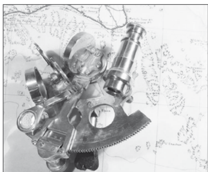
SEXTANTE: instrumento para medir ángulos.
